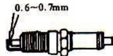
1. Удалите грязевые отложения вокруг кольца свечи зажигания.
